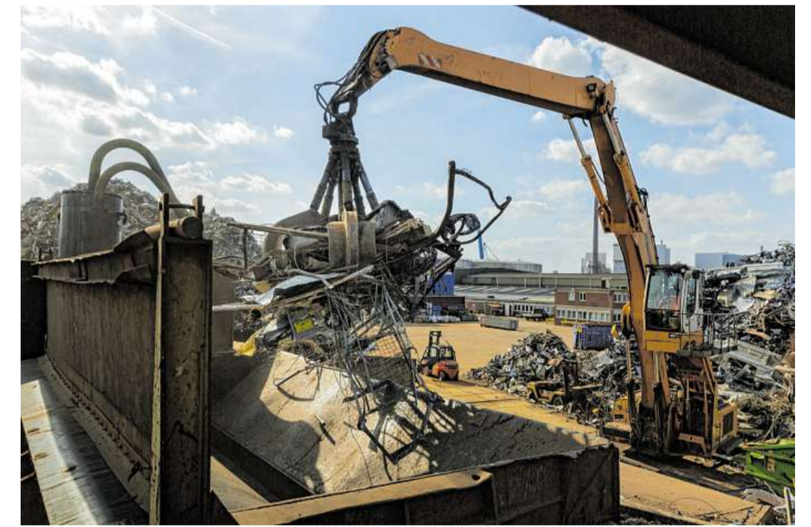
Mit der Spinne schmeißen die Kranfahrer tonnenweise sortierten Schrott in den Schredder.
