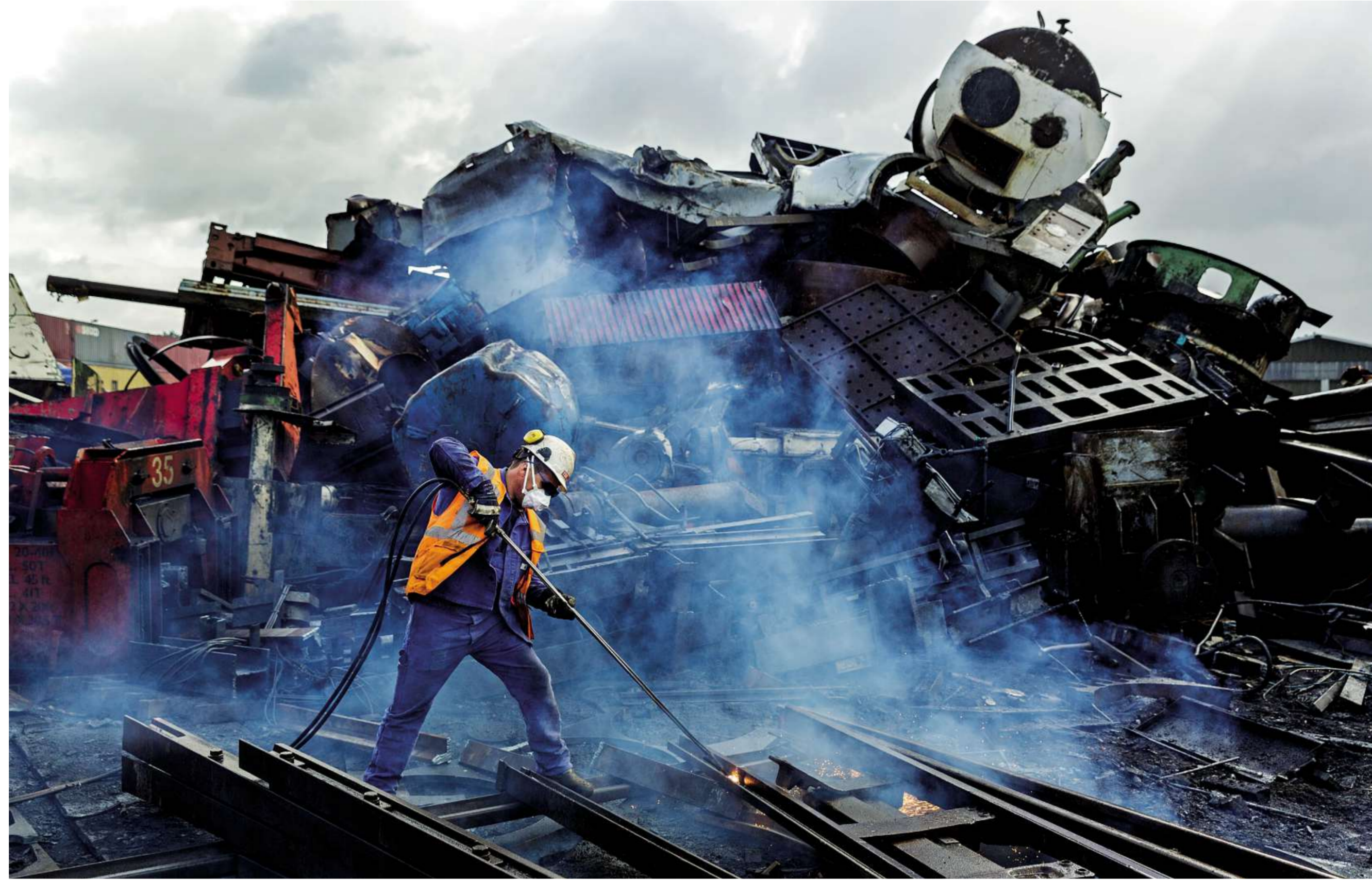
Auf dem Schrottplatz der TSR Recycling in Gröplingen geht es darum, Metallschrott zu sortieren und zu zerkleinern. Hier schneidet ein Arbeiter dicke Stahlschienen mit dem Brenner, an dessen Spitze sich ein Gemisch aus Propangas und Sauerstoff entzündet.
