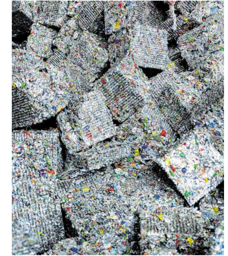
Tausende Aluminiumdosen gepresst zu 20-Kilo-Würfeln.
